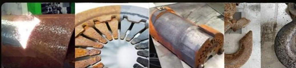
金属表面のサビ落とし
